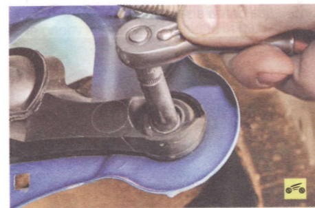
5. ...и бокового крепления глушителя шума впуска...
