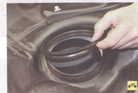
5. Снимите уплотнительное кольцо и осмотрите его. Обязательно замените кольцо, если оно надорвано или сильно обжато.
