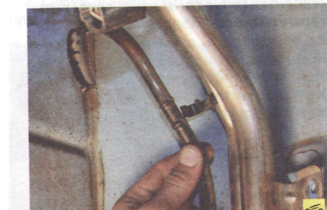
5. Извлеките воздухоотводящую трубку из держателя на наливной трубе.
