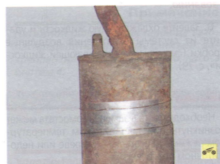
Рис. 5.25. Узлы системы выпуска отработавших газов, расположенные на основании кузова: 1 – выхлопная труба; 2 – основной глушитель; 3 – промежуточная труба; 4 – дополнительный глушитель
