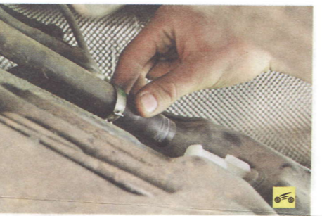
19. ...ослабьте хомут крепления к штуцеру бака воздухоотводящей трубки наливной трубы, сдвиньте хомут по шлангу...
