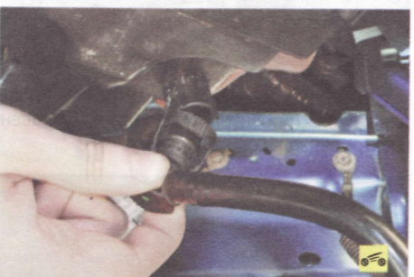
9...приподняв фильтр, отсоедините от штуцера на его корпусе шланг системы вентиляции
