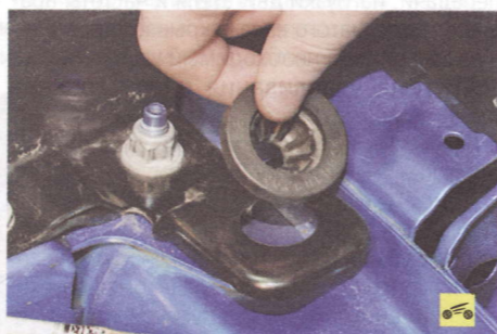
10. Замените затвердевшие или поврежденные подушки крепления воздушного фильтра, вынув их из отверстий кронштейнов.
