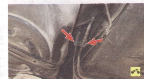
3. Отсоедините от трубопроводов нагнетающий и сливной шланги топливного насоса...
