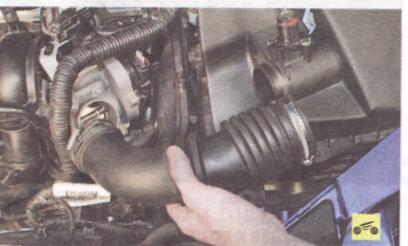
4. ...и, отсоединив от патрубка дроссельного узла...
