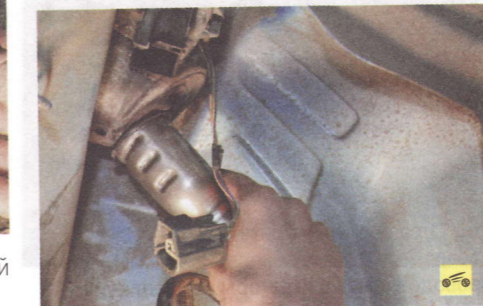
8. Отведите наливную трубу в сторону и извлеките горловину трубы из уплотнителя крышки ее люка.
