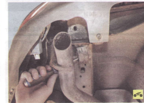
...и задняя часть основного глушителя подвешены на трех одинаковых подушках...
