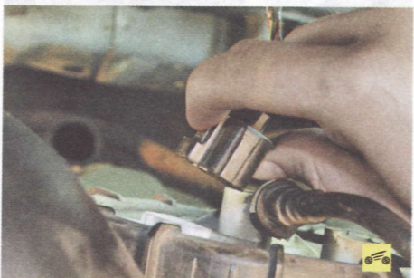
17. Отсоедините от модуля топливного насоса колодку жгута проводов, сжав ее фиксаторы.
