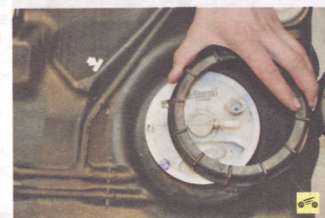
3. ...и отверните кольцо с горловины топливного бака.
