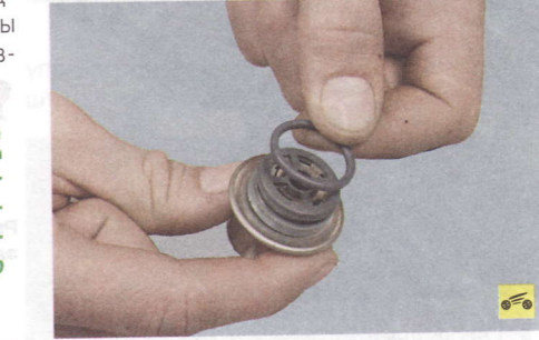
...и снимите его с корпуса компенсатора. Сильно обжатое, затвердевшее или надорванное кольцо замените.
