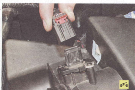
7. ...и отсоедините колодку от датчика.
