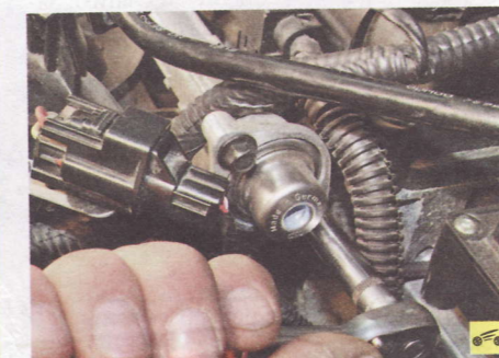
3. Установите компенсатор пульсаций давления топлива в порядке, обратном снятию.
