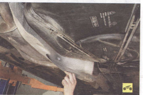
9. Отверните две гайки крепления термоэкрана основного глушителя к хомуту крепления топливного бака...
