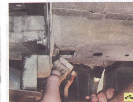
...и выхлопная труба — на двух подушках, различающихся по форме и цвету.
