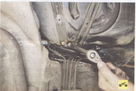
14. Выверните один болт крепления хомута топливного бака к основанию кузова в его передней части...
