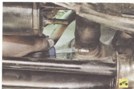
7. Ослабьте затяжку хомута крепления соединительного шланга наливной трубы к патрубку топливного бака...
