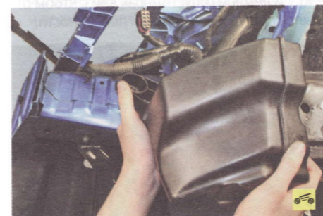
6. ...и снимите глушитель, снимая его горловину с подводящего патрубка корпуса воздушного фильтра.
