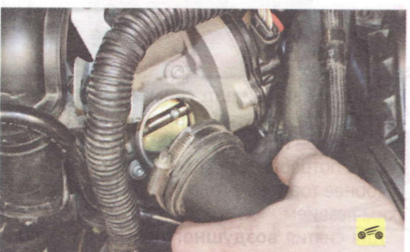
4. ...и, отсоединив от патрубка дроссельного узла...
