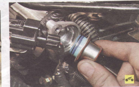
2. ...и извлеките компенсатор из гнезда в топливной рампе.
