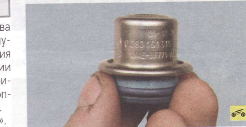
...и снимите его с корпуса компенсатора. Сильно обжатое, затвердевшее или надорванное кольцо замените.
