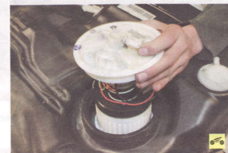
4. Аккуратно извлеките модуль топливного насоса, поворачивая его так, чтобы не повредить или не сместить поплавков датчика указателя уровня топлива, и слейте из него топливо в заранее подготовленную емкость.
