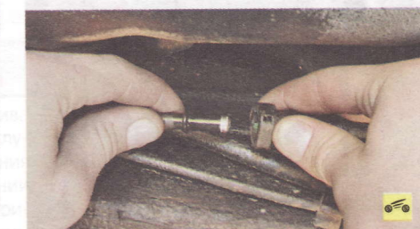
4. ...сжав их фиксаторы.
