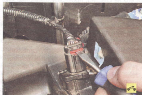
6. Поддев отверткой, приподнимите вверх фиксатор колодки жгута проводов датчика массового расхода воздуха...
