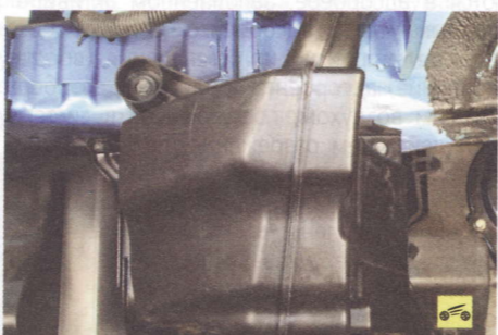
11. Установите воздушный фильтр в порядке, обратном снятию.
